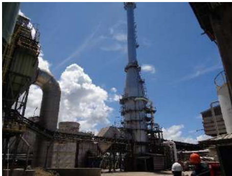
ภาพที่ 2.2-2 Wet Scrubber และ dry Scrubber
