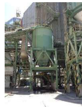
ภาพที่ 2.2-31 ไซโลหรือ Collecting Pit เก็บถ่านหินแบบปิด
